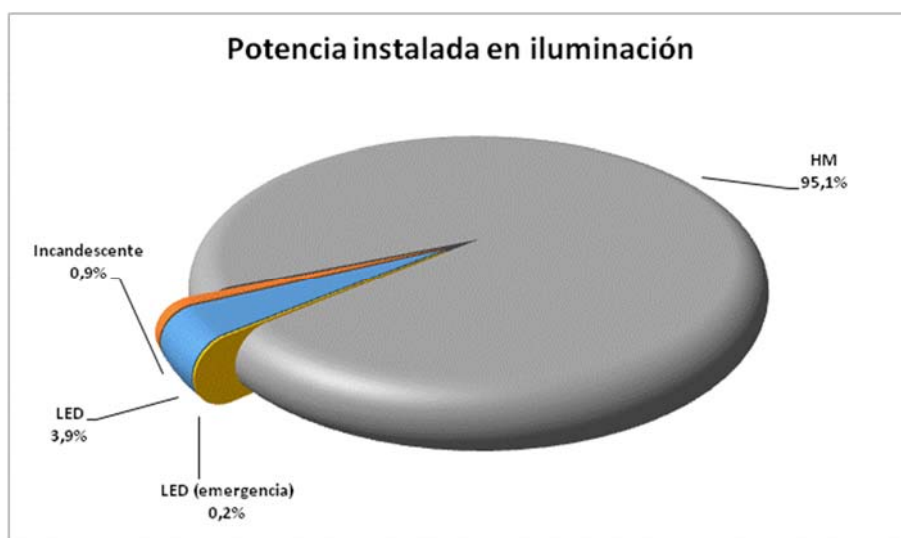
Gráfica 5. Distribución de la potencia instalada en iluminación según tipo de lámpara
